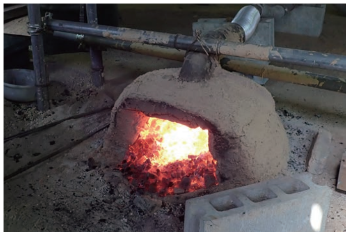
古代中国炒鋼炉の復元と実験
